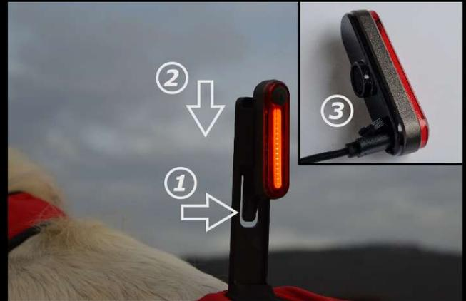
Entriegel die Leuchte durch Eindrücken der Raste **①** und schiebe die Leuchte aus der Führung **②**. Schließe die Leuchte per USB **③** an ein Ladegerät an.
