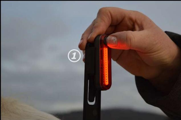
Schalte das Rücklicht durch längeres Drücken des An-/Ausschalters ein **①**. Durch nochmaliges kurzes Drücken des Schalters kannst du zwischen den 4 verschiedenen Leuchtmodi wechseln. Ein erneutes langes Drücken des Schalters schaltet das Rücklicht wieder aus.
